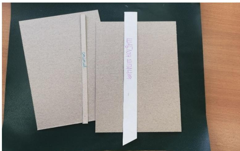
Разметка на крышке для сборки переплётной крышки (15мм.).
